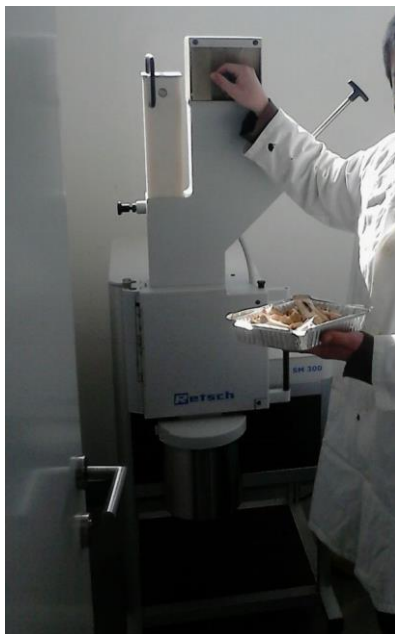
Slika 10. Mlin Retsch SM 300
