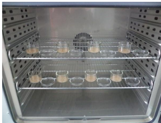
Slika 13. Uzorci u sušioniku Binder FD 115
