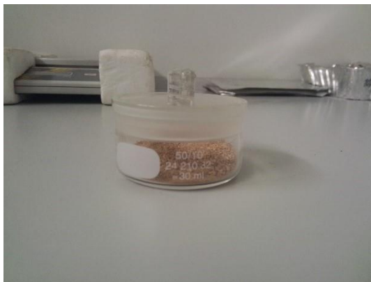
Slika 12. Uzorak spreman za ispitivanje vlage
