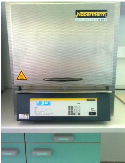
Slika 16. Peć za žarenje Nabertherm L911
