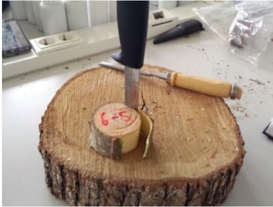
Slika 8. Postupak odvajanja kore od drva
