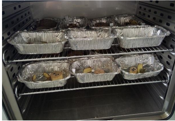
Slika 9. Uzorci u sušioniku Binder FD 115
