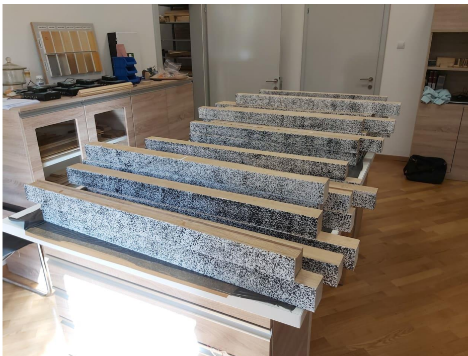
SLIKA 12. Uzorci pripremljeni za ispitivanje deformacija pri savijanju
