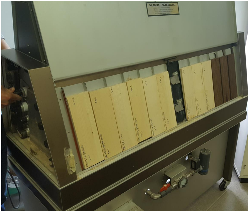
Slika 6. Uzorci pričvršćeni na nosače i postavljeni u QUV uređaj
