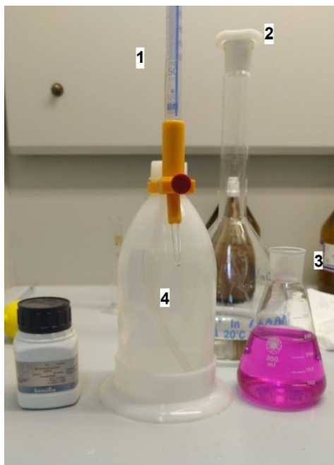
Slika 14. Postupak titracije; 1 – bureta volumena 50 mL, 2 – odmjerna tikvica sa standardiziranom otopinom natrijevog hidroksida, 3 – slijepa proba u Erlenmeyer-ovoj tikvici nakon završene titracije, 4 – plastična bočica s otopinom iz odmjerne tikvice koja služi za punjenje burete
