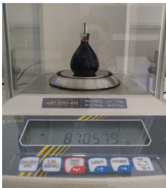
Slika 8. Mjernje mase piknometra i utekućenog drva na analitičkoj vazi
