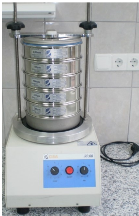
Slika 4. Laboratorijska elektromagnetna tresilica, namijenjena za prosijavanje uzoraka
