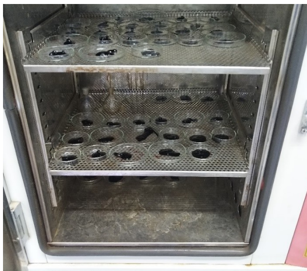
Slika 10. Na slici su prikazani uzorci postavljeni na označene Petrij-eve zdjelice i ostavljeni na sušenje pri temperaturi od 150^{\circ}\text{C} na period od 24 h
