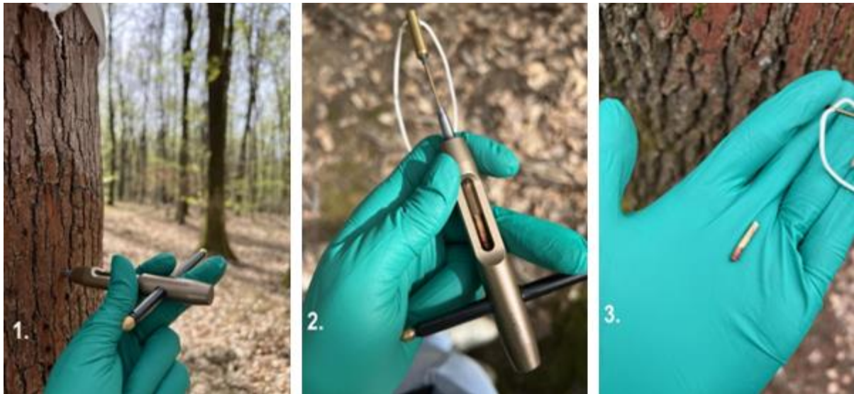
Slika 16. koraci uzimanja uzoraka Trephorom
