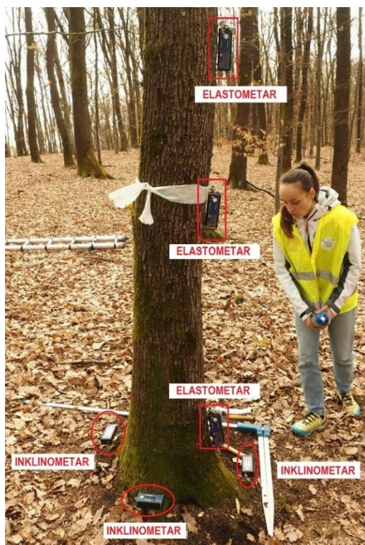
Slika 14. Položaj elastometara i inklinometara na stablu
