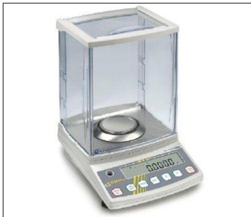
Slika 13: Analitička vaga za vaganje s točnošću od  $\pm 0,0001\ \text{g}$  [4]
