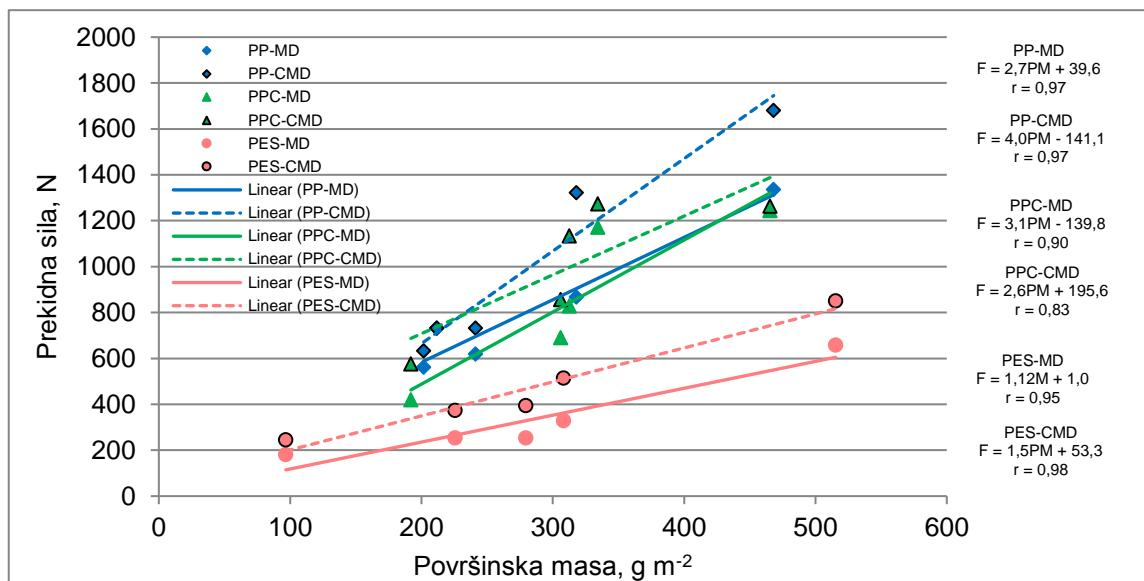
Slika 21: Prekidna sila netkanog tekstila u MD i CMD smjeru u ovisnosti o površinskoj masi
