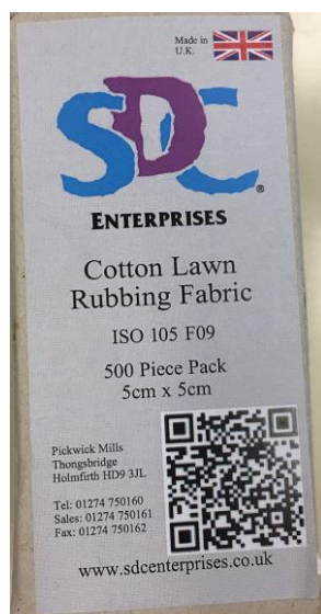
Slika 17. Karakteristike primjenjene popratne standardne tkanine za ispitivanje postojanosti obojenja na trljanje
