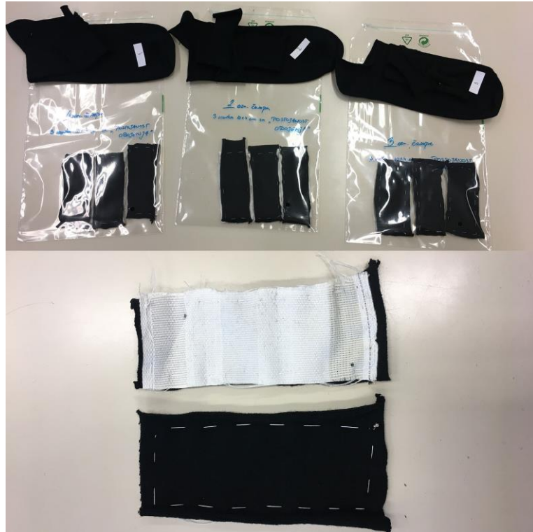
Slika 19. Pripremljeni uzorci za ispitivanje postojanosti obojenja
