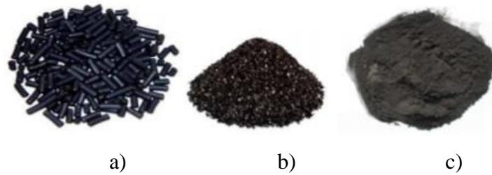
Sl. 7 Aktivni ugljen: a) peletirani, b) granulirani, c) praškasti
