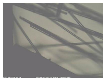
Mikroskopsko određivanje točke taljenja (16x)
