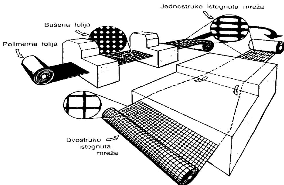
Slika 4 Shematski prikaz postupka proizvodnje mreža sustava Tensar [6]
