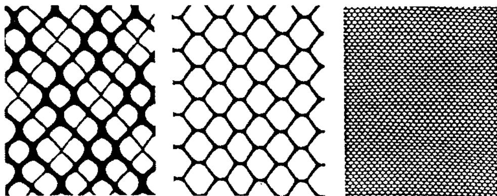
Slika 3 Oblici mreža proizvedenih sustavom Netlon [6]
