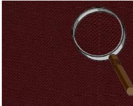
Sl. 3. Pogreška u tkanini: nedostatak osnovine niti [6]
