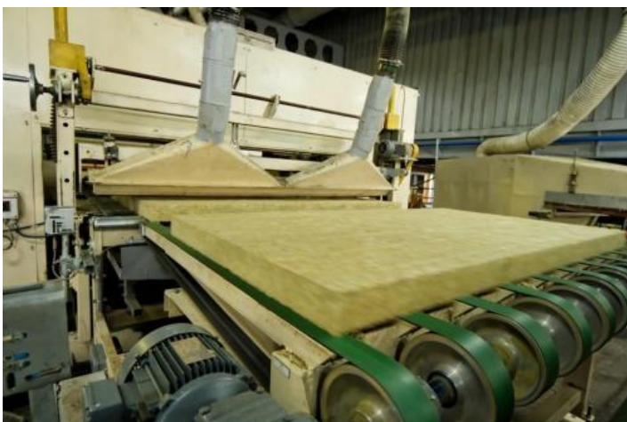
Slika 9. Rezanje vune na željene dimenzije
