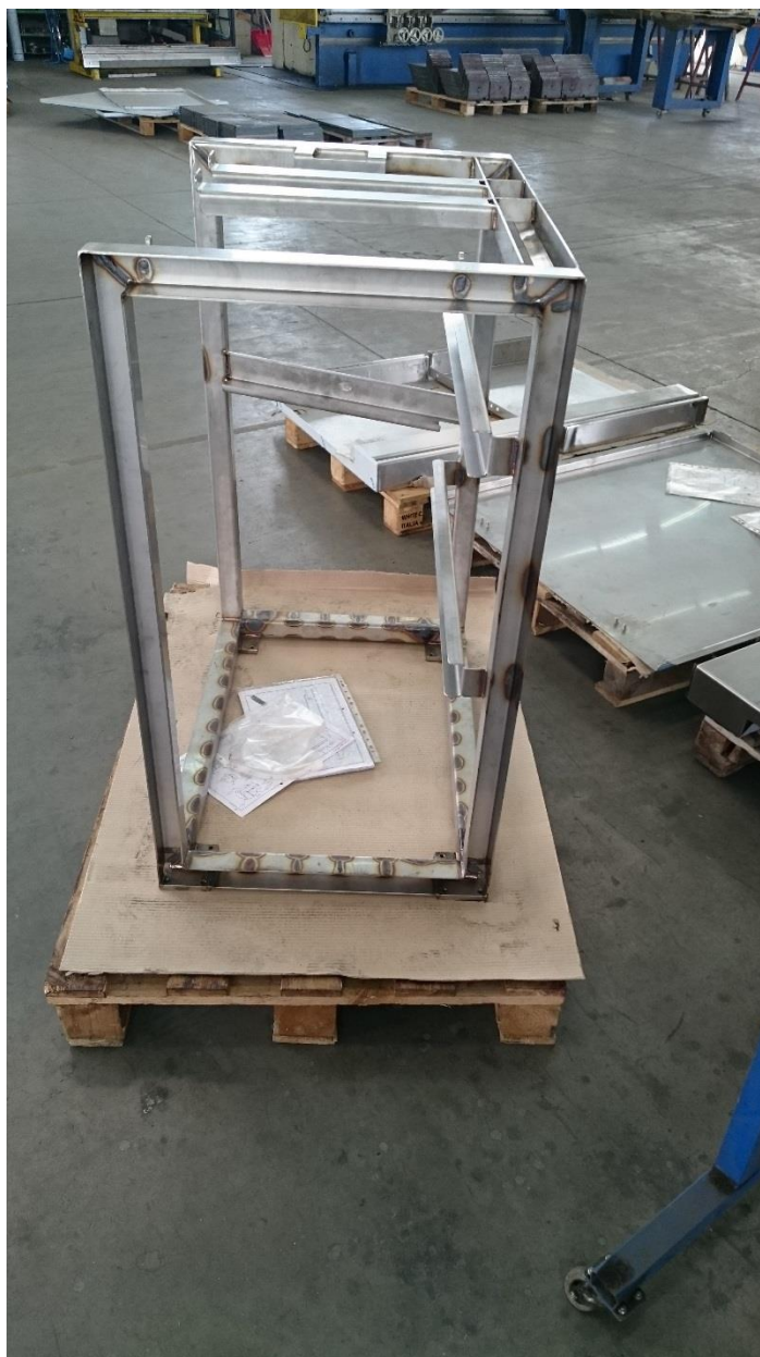
Slika 4.35. Kolica nakon zavarivanja
