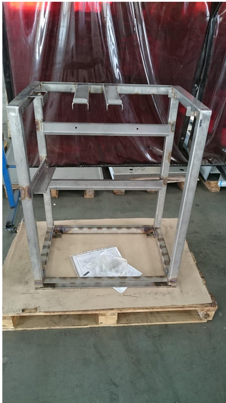
Slika 4.36. Kolica nakon zavarivanja (druga strana)
