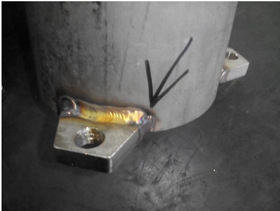
Slika 4.53. Greška kod zavarivanja – rupa na površini zavora
