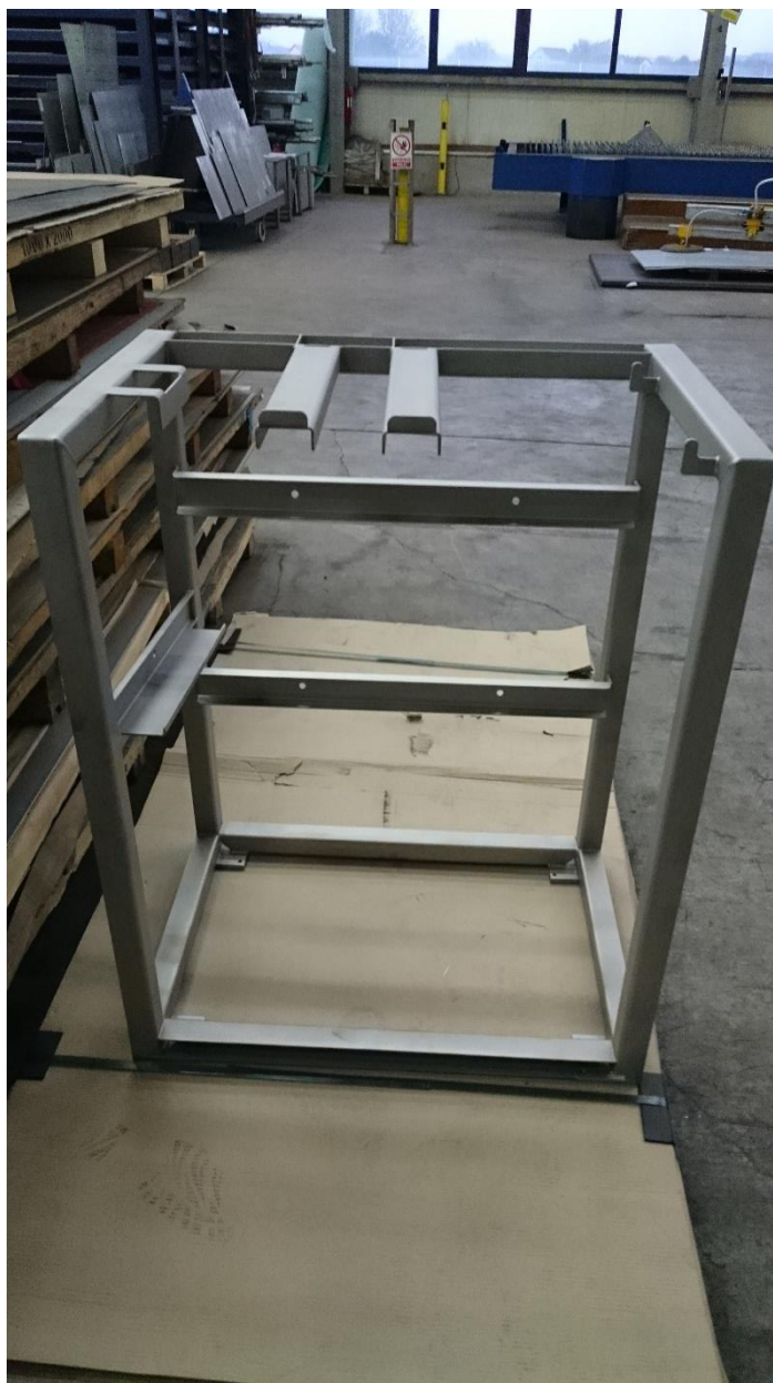
Slika 4.37. Kolica nakon sačmarenja
