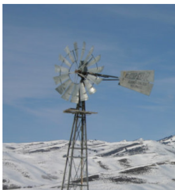
Slika 4.7 Američki tip vjetroturbine [21]
