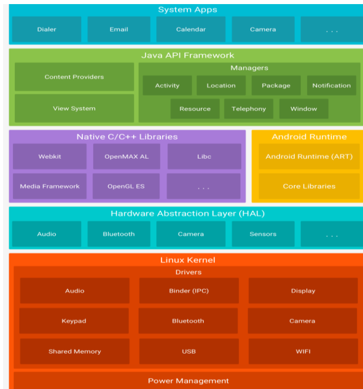
Slika 3: Arhitektura Android OS-a [5]
