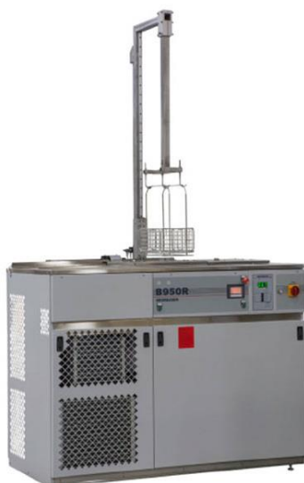
Slika 46.: Oprema za parno odmašćivanje [39]
