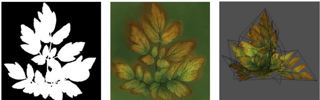
Slika 2.6 Primjer alpha mape, mape boja, te tih mapa zajedno na modelu
