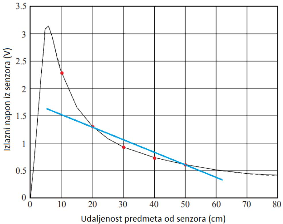
Slika 4.8 Prikaz pravca dobivenog linearizacijom staticke karakteristike.
