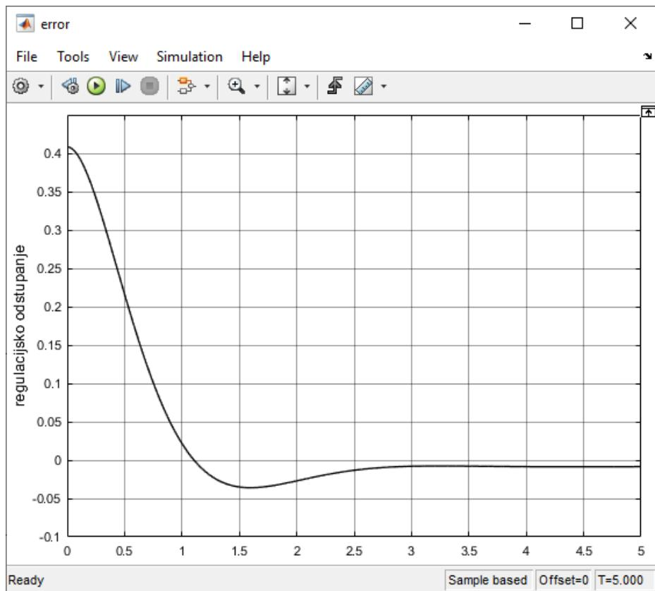
Slika 5.7 Promjena regulacijskog odstupanja u vremenu
