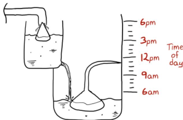
Slika 1.1 Pojednostavljeni prikaz Ktesibijevog vodenog sata [1]
