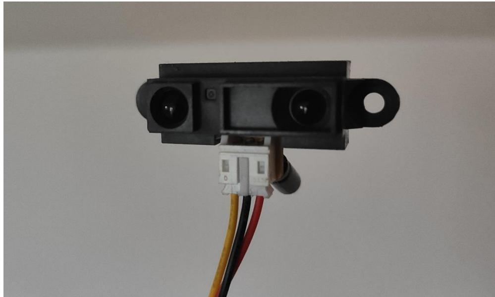
*Slika 4.5 Prikaz prednje strane Sharp IR GP2Y0A21YK0F senzora*
