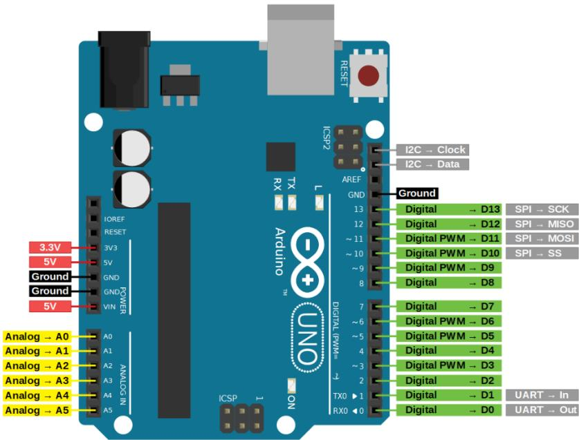
Slika 2.5 Prikaz pinova i njihovih funkcija na Arduino Uno pločici [3]
