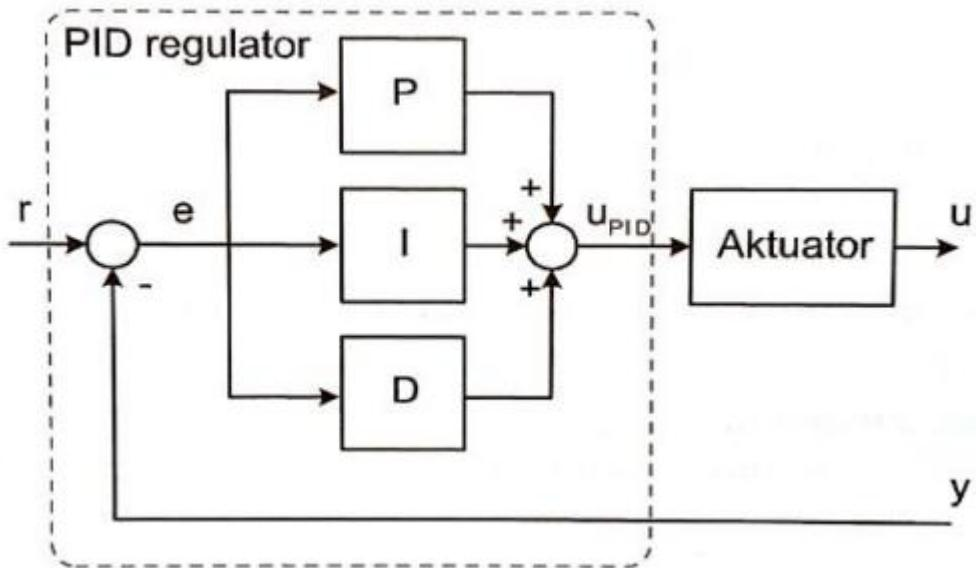
Slika 2.3 Struktura PID regulatora prikazana blok dijagramom [2]
