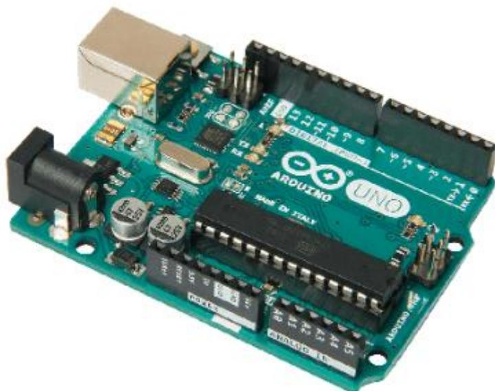
Slika 2.4 Prikaz Arduino Uno pločice
