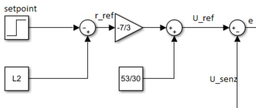
Slika 5.3 Prikaz dobivanja regulacijskog odstupanja usporedbom napona
