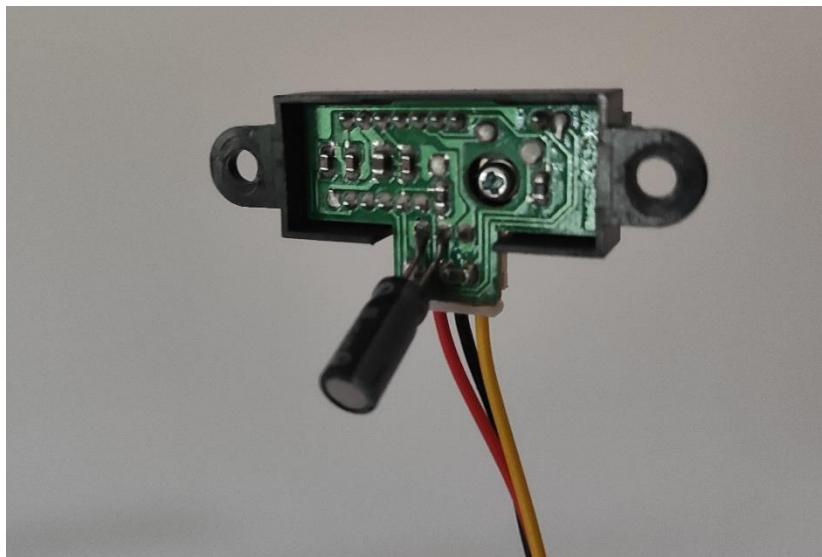
*Slika 4.7 Prikaz montiranog kondenzatora na stražnju stranu senzora*
