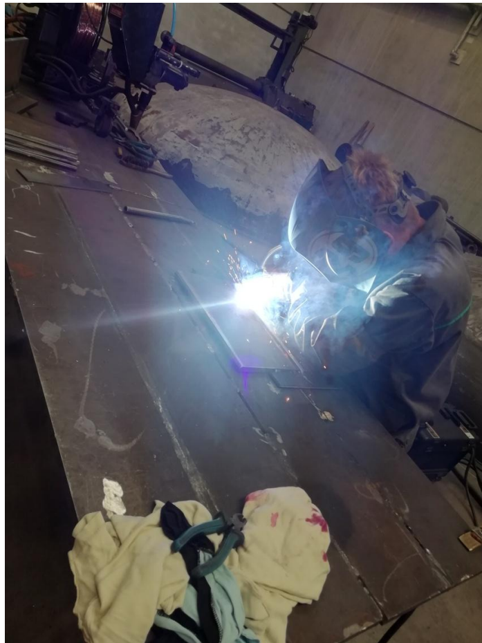
Slika 9.3. Zavarivanje popune sučeljenog spoja u PA položaju
