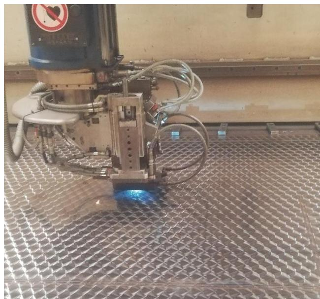
Slika 29. Lasersko zavarivanje duplikatora na Laser Cell-u 7040
