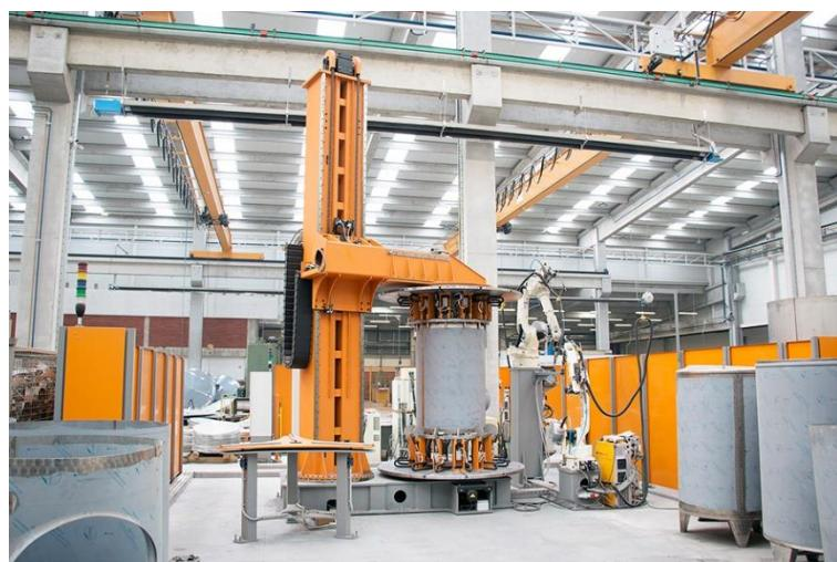
Slika 31. Roboti za lasersko zavarivanje plašta
