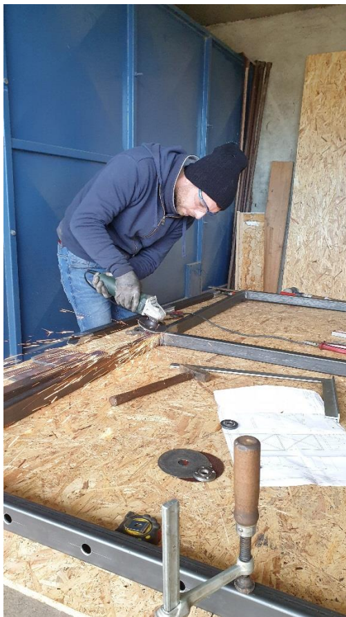
Slika 75. Brušenje i obrada zavora
