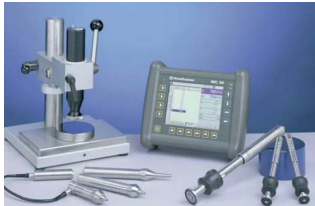
Slika 25. Uređaj za ispitivanje tvrdoće MIC20 metodom odskoka i UCI [2]
