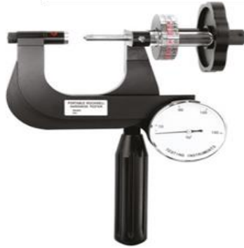
Slika 26. Prijenosni ručni uređaji za ispitivanje tvrdoće po Rockwell-u [14]
