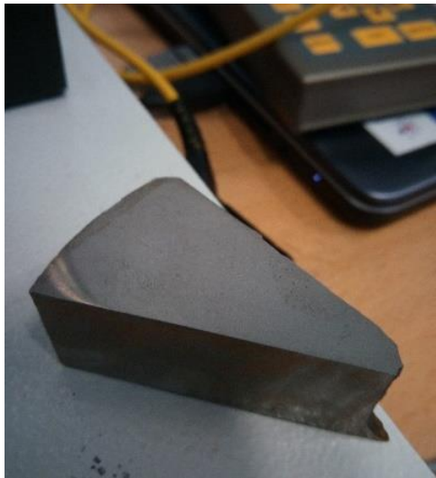
Slika 37. Uzorak od sivog lijeva pripremljen za ispitivanje tvrdoće
