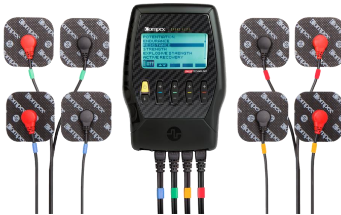
Slika 16.1.3. - COMPEX uređaj za stimulaciju mišića
