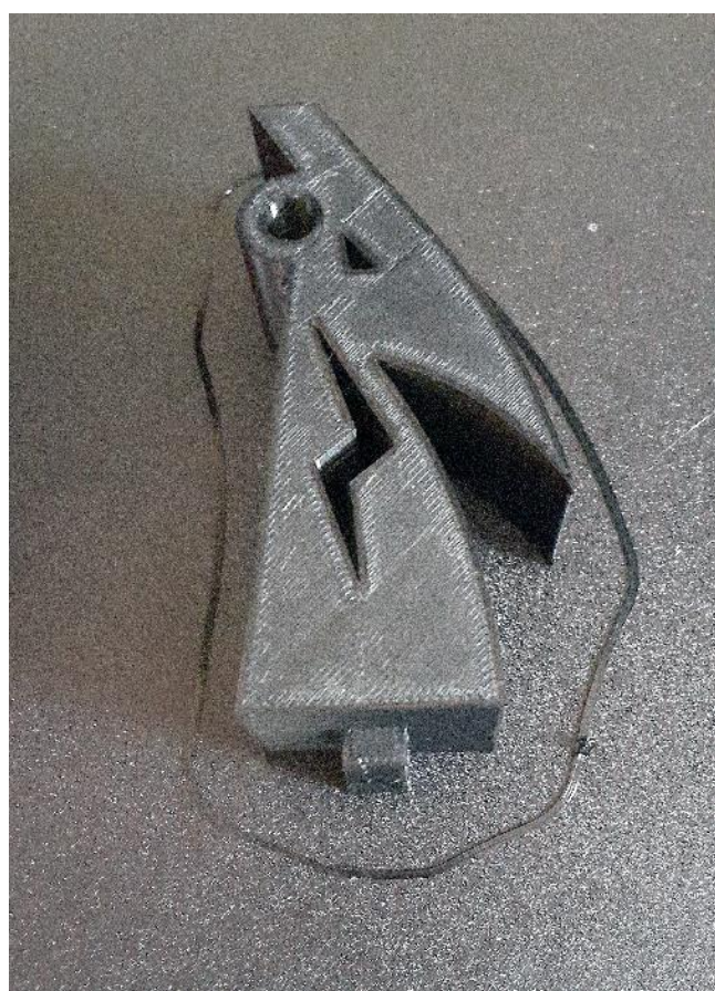
Slika 7.17 3D ispisani bazni dio luka
