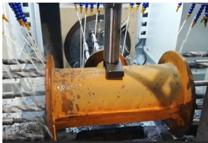
Slika 85 Stezanje komada hidrauličkim cilindrom
