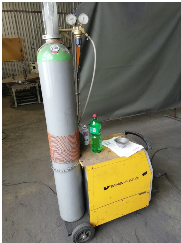
Slika 48 Aparat za varenje VARMIG 331
