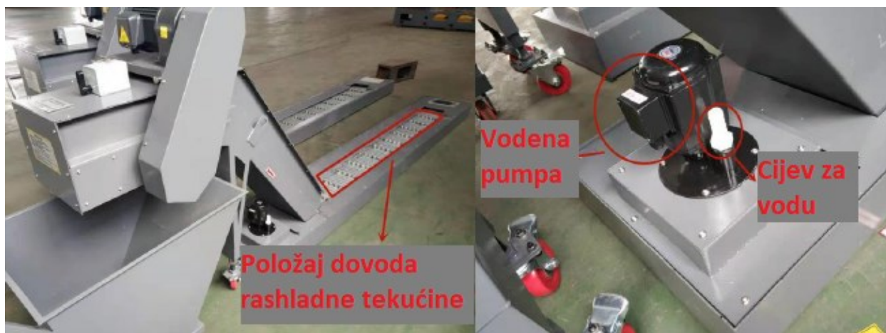
Slika 27 Dovod rashladne tekućine [10]
