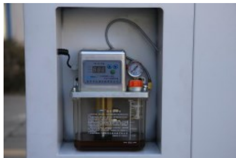
Slika 19 Uređaj za podmazivanje [10]
