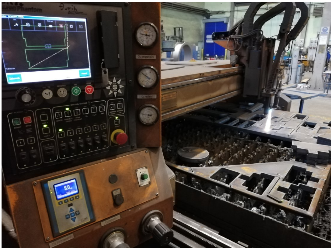
Slika 47 Rezanje ploče na plazma rezaču
