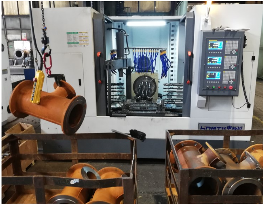
Slika 84 Dizanje komada dizalicom
