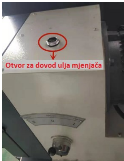
Slika 23 Dovod ulja mjenjača [10]
