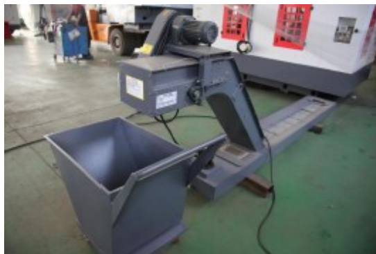
Slika 20 Transporter za uklanjanje strugotine [10]
