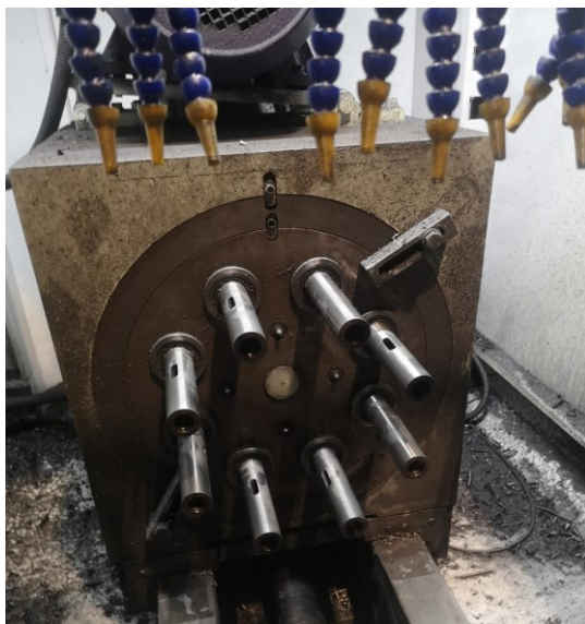
Slika 71 Glava za bušenje prije čišćenja
