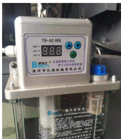
Slika 24 Automatska pumpa za ulje [10]
