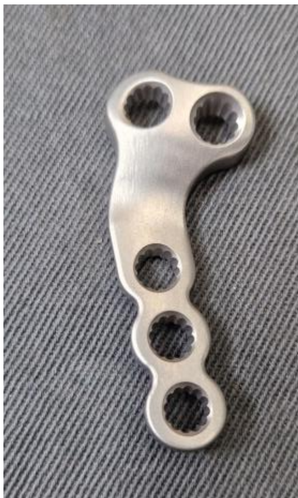
Slika 20. Pločica nakon kugličarenja
