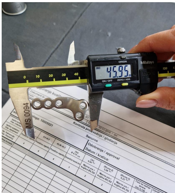
Slika 38. Mjerenje pomičnim mjerilom
