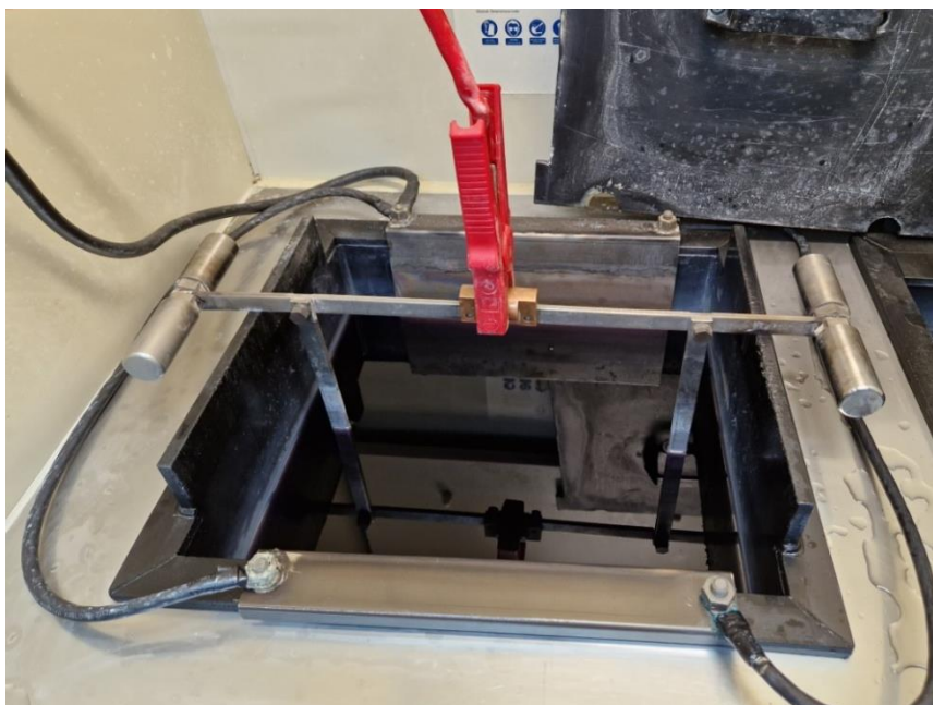
Slika 25. Pričvršćivanje spojnice na stalak
