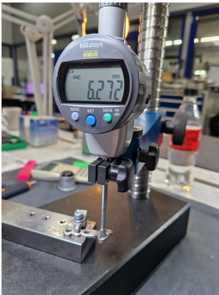
Slika 37. Mjerenje visine kuglice
