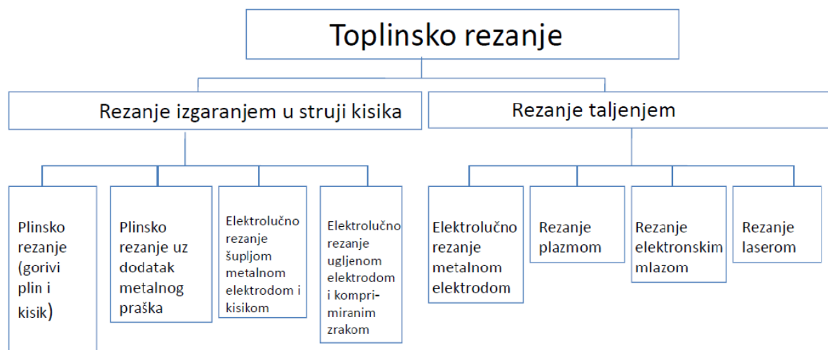
Slika 1. Podjela toplinskih postupaka rezanja [1]
