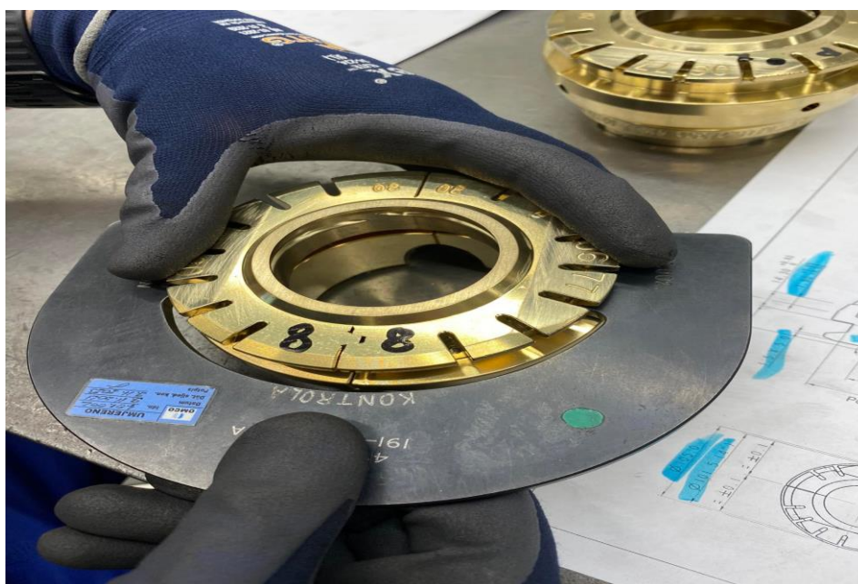
Slika 28. Mjerenje promjera prizme kalibrom [28]
