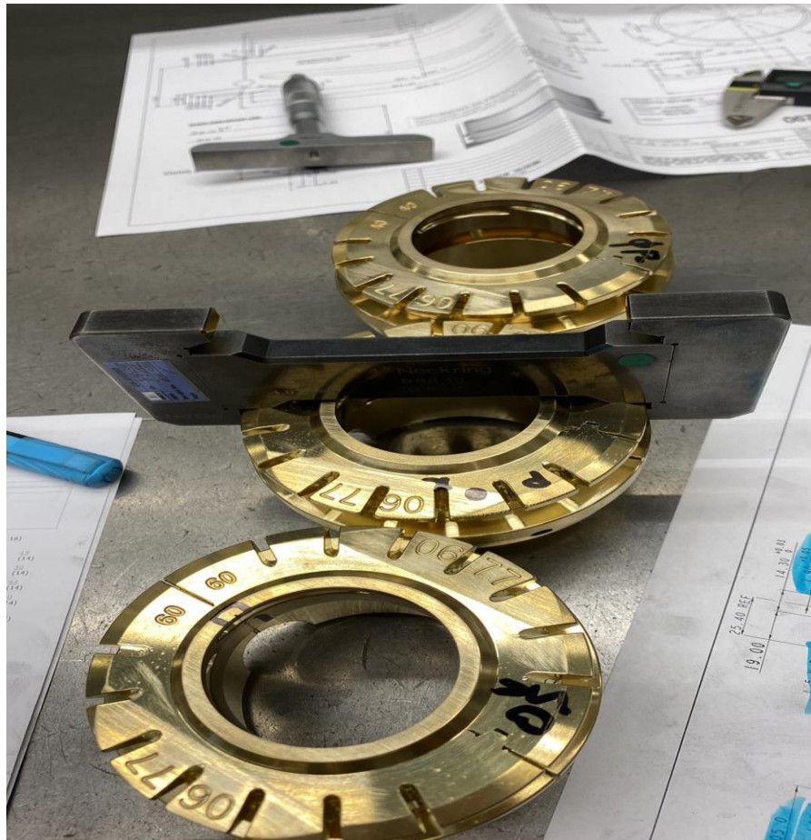
Slika 29. Mjerenje visine prizme kalibrom [28]
