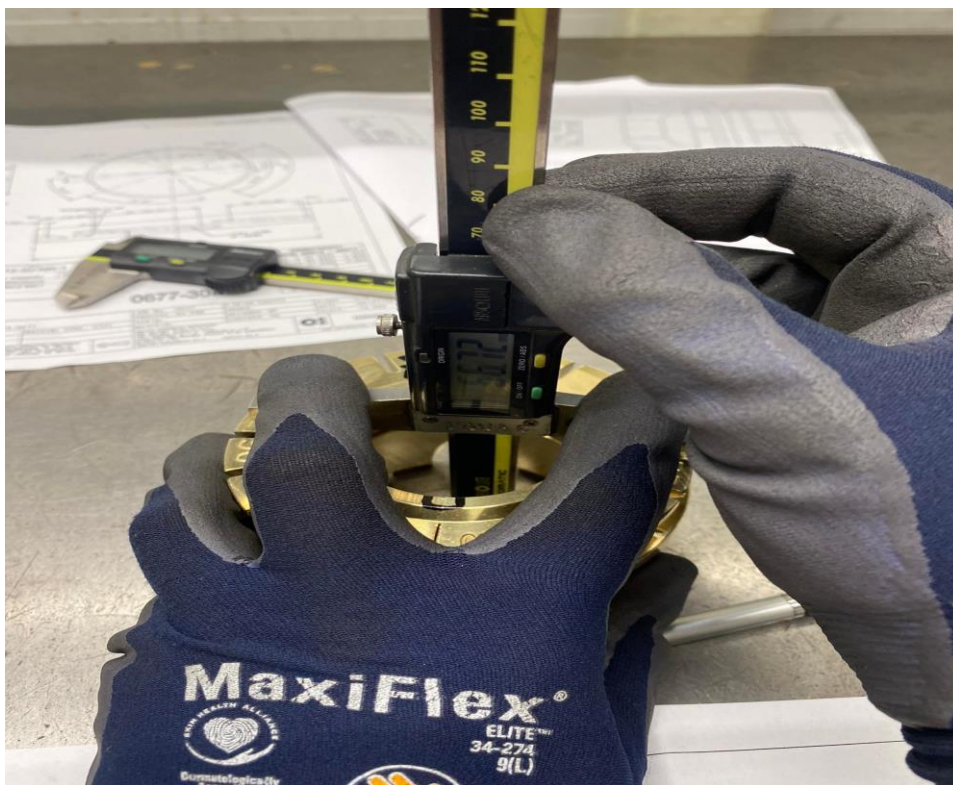
Slika 27. Mjerenje ukupne visine pomičnim mjerilom [28]
