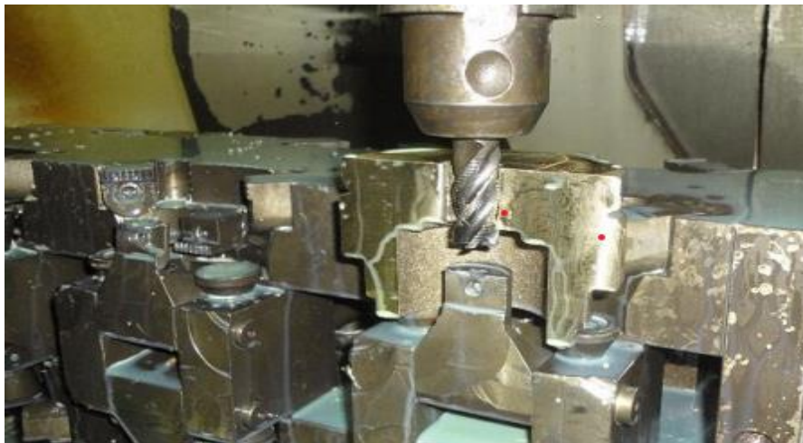
Slika 21. Glodanje promjera do metalizacije [27]
