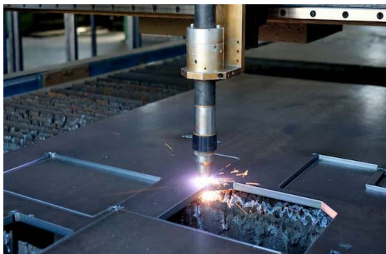
Slika 6. Prikaz plazma rezanja na CNC plazma rezaču [11]
