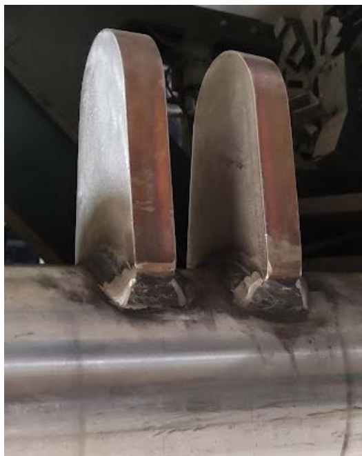
Slika 38. Kutni zavar po zatvorenoj konturi nakon čišćenja [28]
