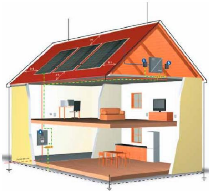
Slika 19. Gromobranska instalacija građevine [5].
