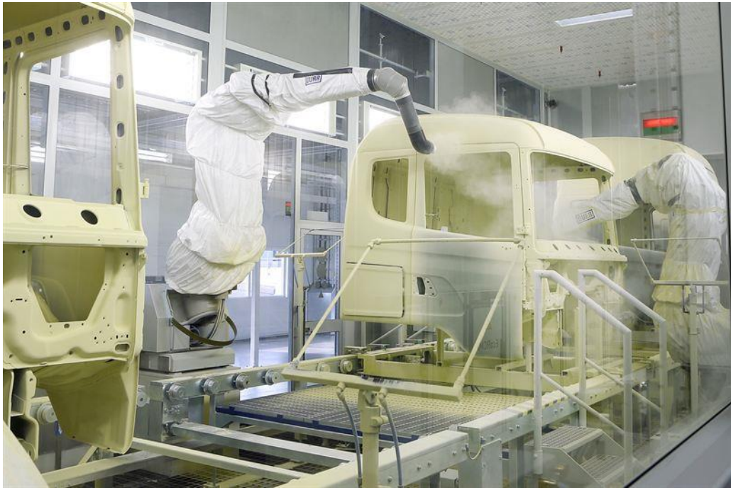
Slika 11 Kabina kamiona i proces njenog farbanja
