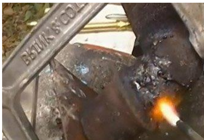
Slika 7.6. Lemljenje lijevanog željeza [21]
