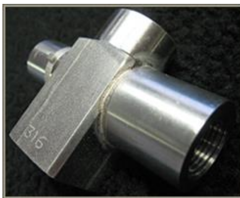
Slika 7.1. Lemljenje nehrđajućeg čelika [18]
