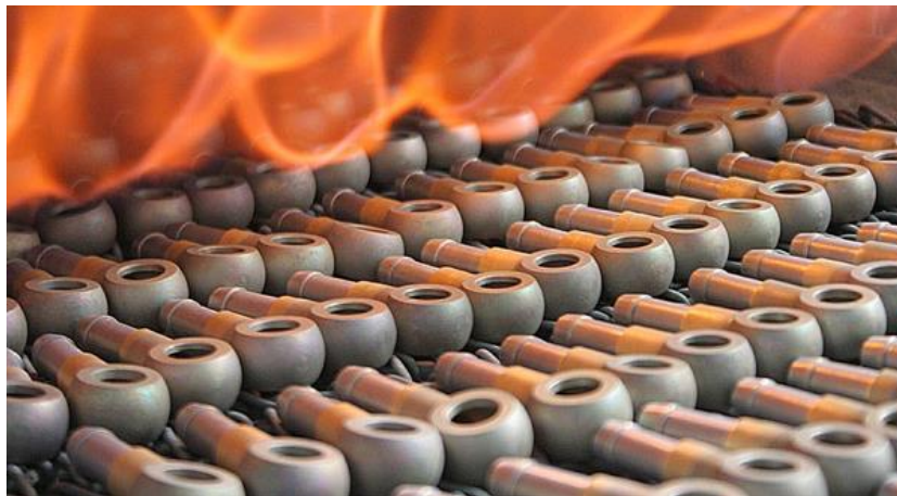
Slika 2.8. Lemljenje u pećima [14]
