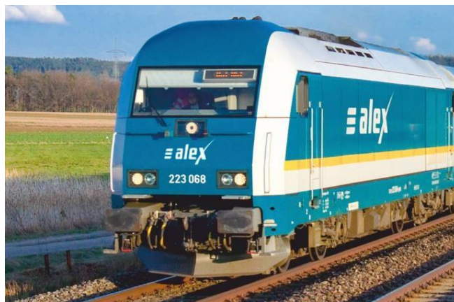
Slika 35. Dizel električna lokomotiva serije 1223 (ER 20) SIEMENS
