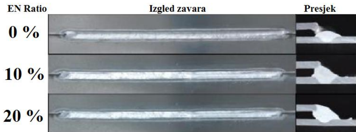
Slika 9.9 Utjecaj negativnog polariteta pri spajanju aluminijske legure (AC MIG) [23]
