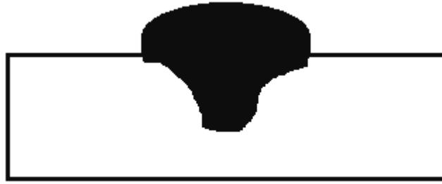
Slika 6.1 Utjecaj zaštitnog plina argona na geometriju zavora
