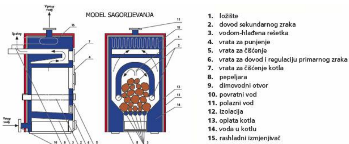
Slika 2.2 Opis dijelova kotla na kruta goriva
