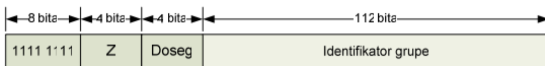
Slika 12: Struktura multicast adrese
