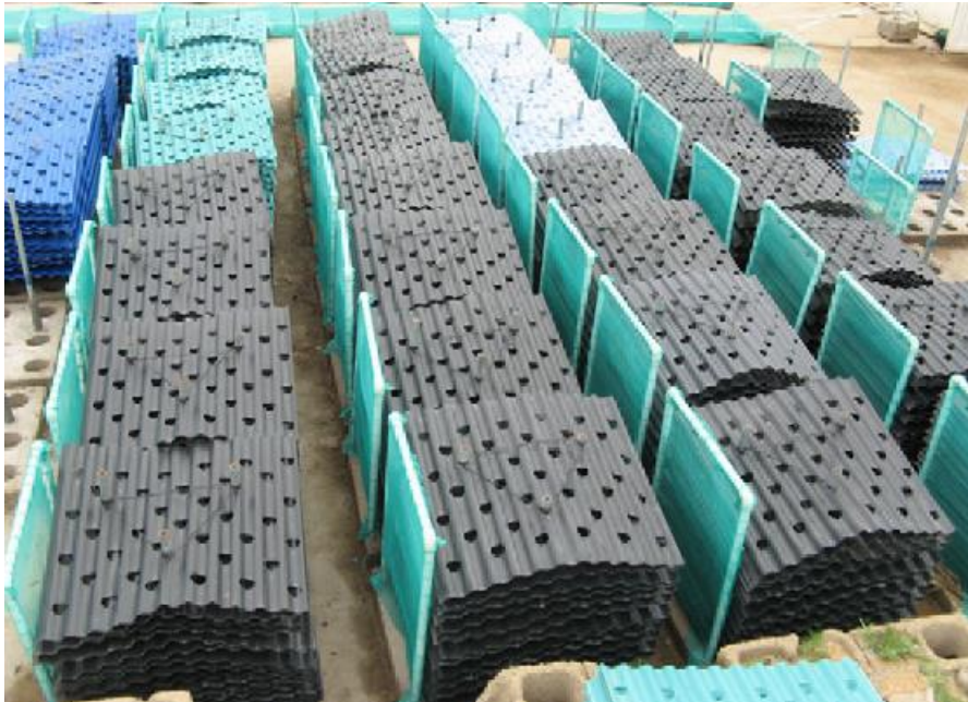
Slika 13. Višeslojni trodimenzionalni umjetni grebeni. (Izvor: Libin Zhang, 2015)
