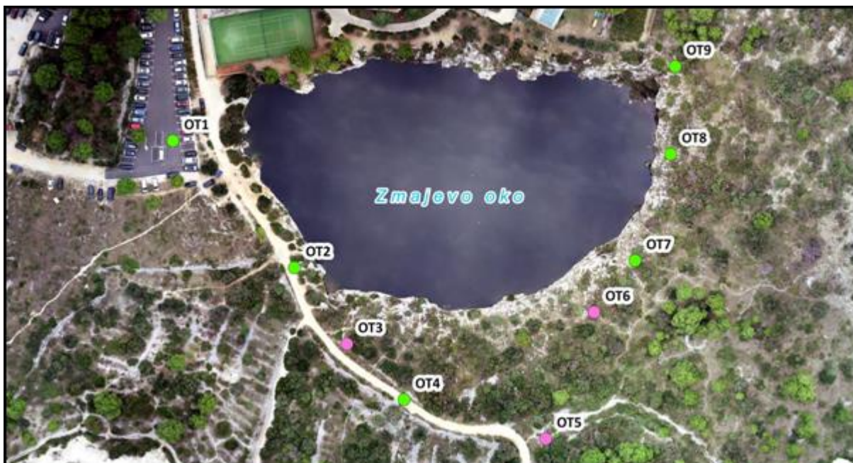
Slika 8. Distribucija orijentacijskih i kontrolnih točaka oko jezera Zmajevsko oko
