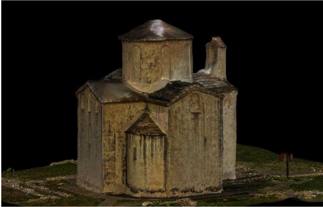
Slika 48. Greške na modelu nastale zbog manjka prikupljenih točaka
