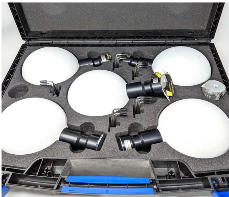
Slika 21. Referentne sfere (URL26)
