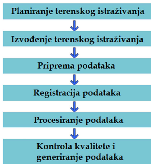
Slika 19. Tijek rada s terestričkim laserskim skenerom (preuzeto od Van Genechten i dr., 2008)
