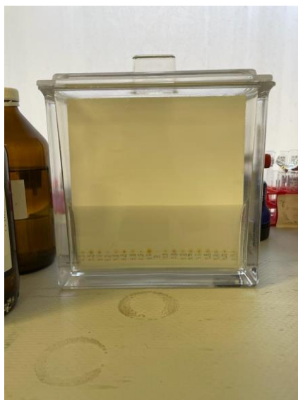
Slika 16. Kupelj sa mobilnom fazom za razvoj kromatografske migracije (Izvor: Lucija Bronić, 2023.)
