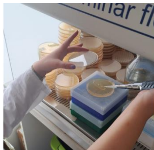
Slika 7. Inokulacija suspenzije na podlogu MEA (Izvor: J. Lončar, 2023.)
