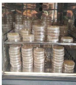
Slika 8. Inkubiranje suspenzije na podlozi MEA (Izvor: J. Lončar, 2023.)
