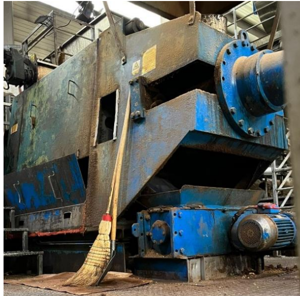
Slika 21. Preša pogona za preradu materijala kategorije 1 i 2 (foto: Josipa Lovasić)
