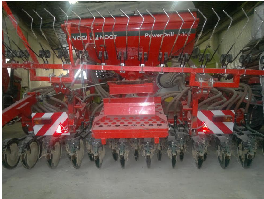
Slika 8. Pneumatska sijačica VogelNoot Power Drill A300 (Izvor: V. Miloš)
