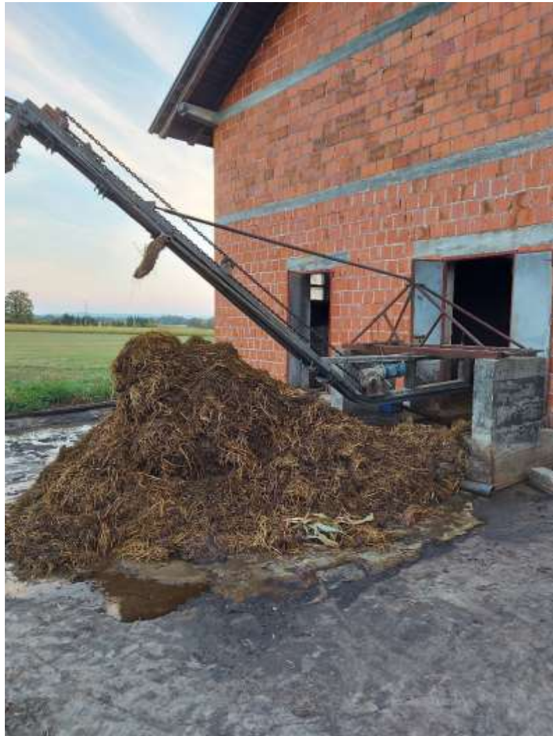
Slika 16. Vanjski transporter za gnoj
