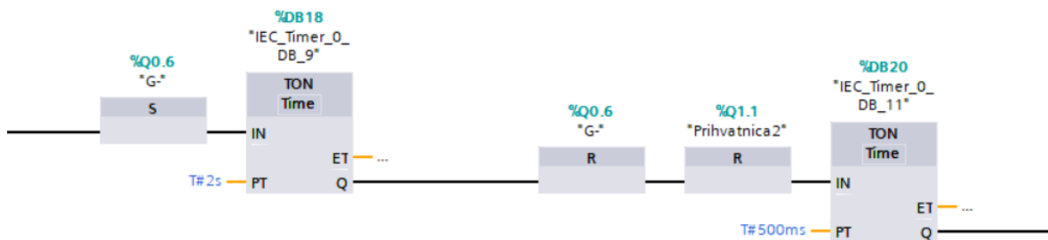
Slika 5.15 Prikaz daljnjeg procesa gdje prihvatnica zaokretnog cilindra prenosi dio do ispitnog komada
