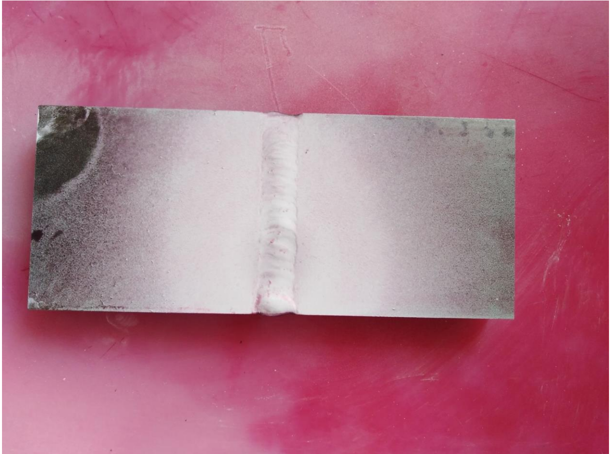
Slika 39 Ispitni objekt 1 razvijač osušen
