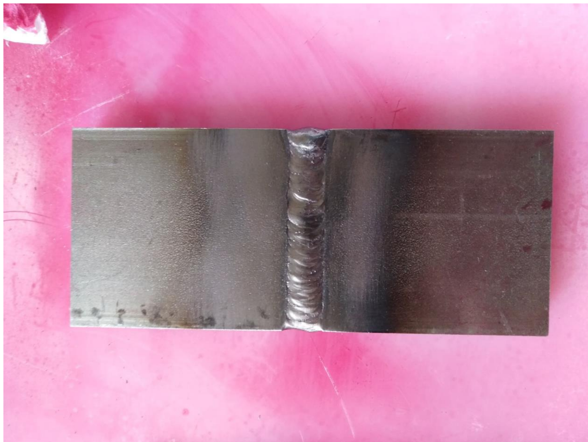
Slika 35 Očišćeni ispitni objekt 1 spreman za nanošenje penetranta
