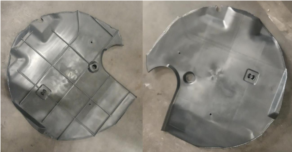
Slika 50. Dio proizvoda dobiven ubrizgavanjem sa sapnicom broj 3
