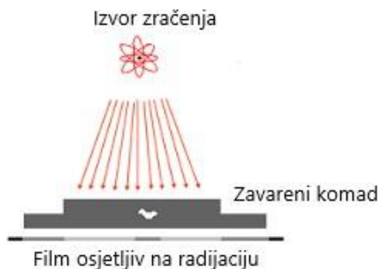
Slika 35. Shema radiografske metode [29]
