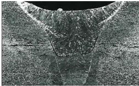
Slika 32. Pogreške naljepljivanja među slojevima [24]
