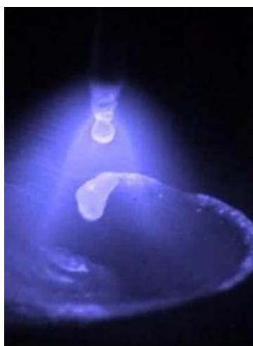
Slika 10. Realni prikaz metala štrcajućim lukom [12]
