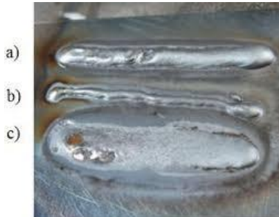
Slika 21. Realni prikaz zavora [20]
