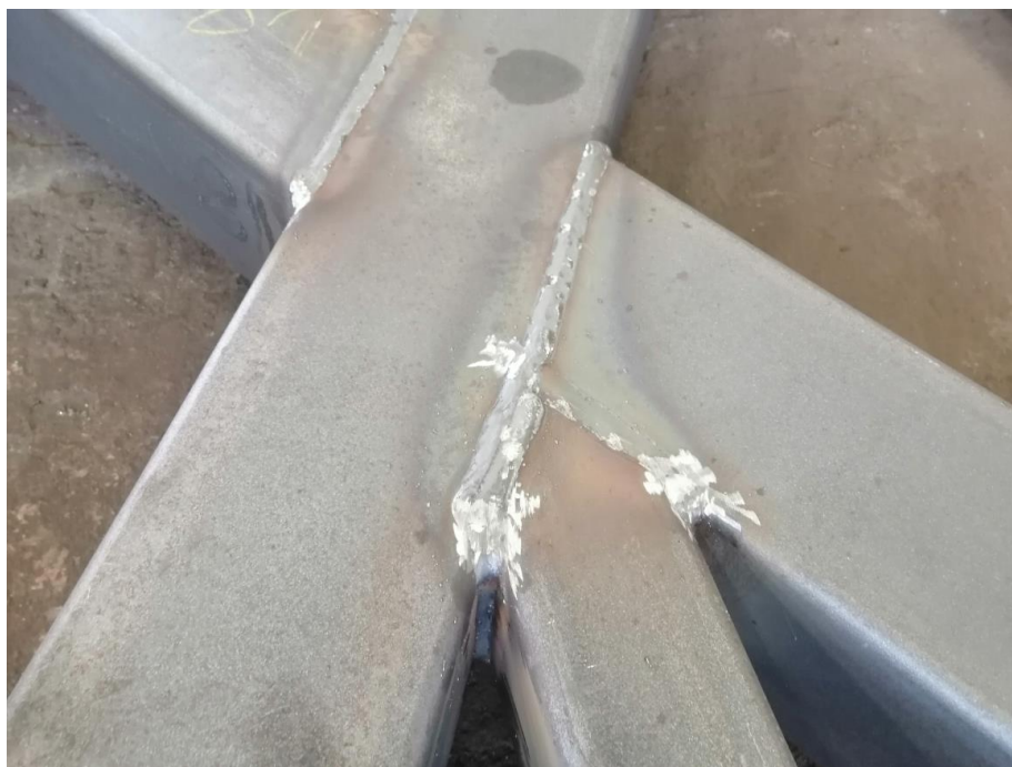
Slika 60. Zavar sklopa kvadratnih cijevi
