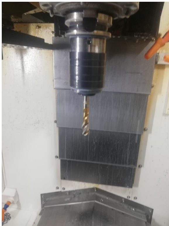
Slika 50. Ureznik HSS-E sa TiN presvlakom
