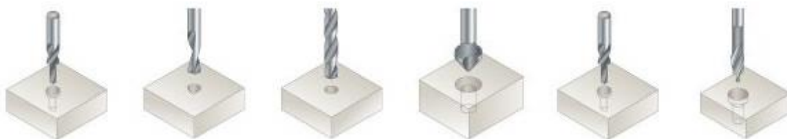
Slika 7. Obrada bušenja, zabušivanja, proširivanja ( razvrtavanja ) i upuštanja rupa [16]
