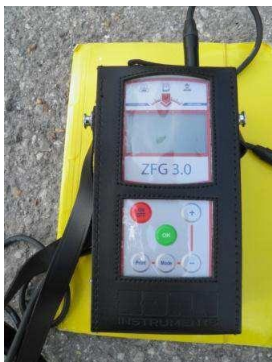
Slika 6. Prijenosno računalo deflektometra (Branišelj, S. 2013)
